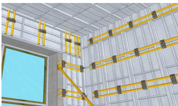
图 4.64 现浇楼板铝模安装
