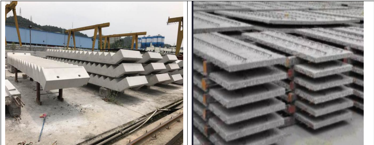
图 3.17 预制构件成品的堆放及养护
