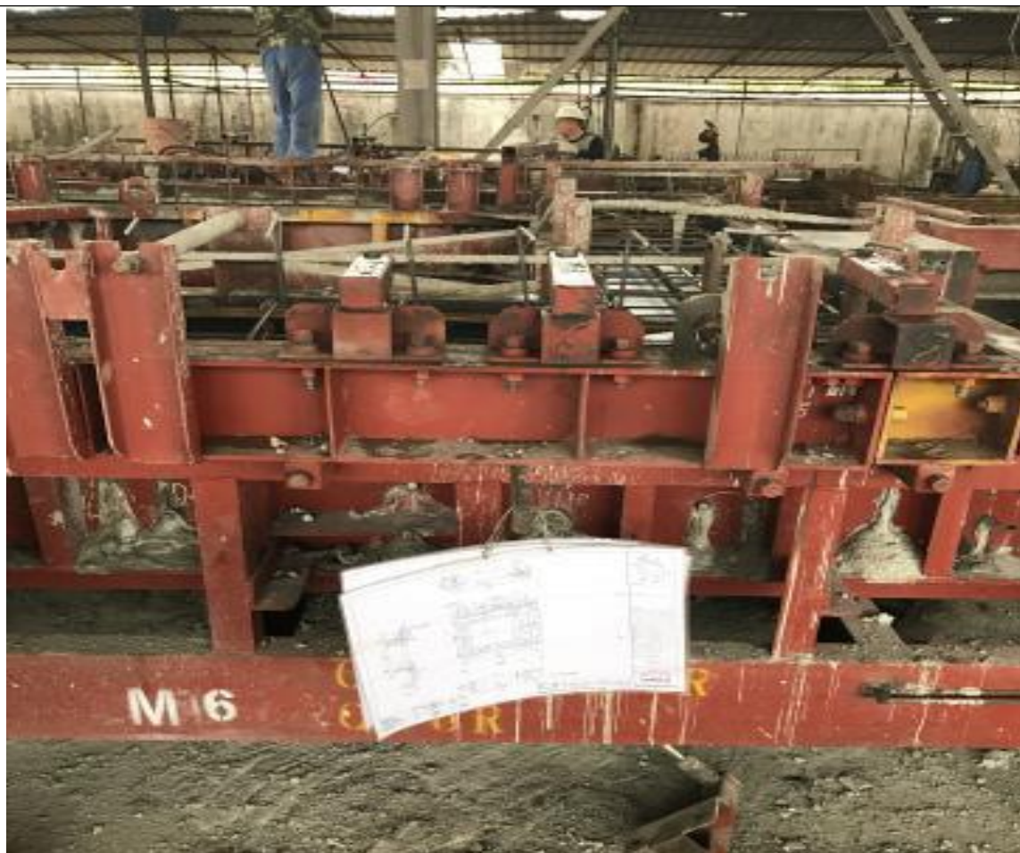
图 3.11 预制构件模具拼装
